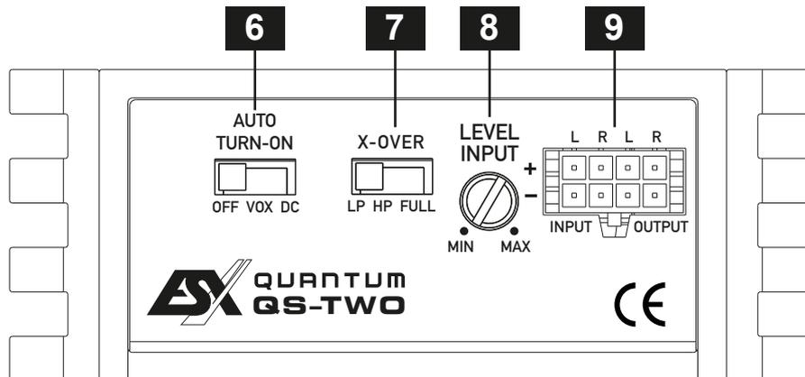
**6** Falls Ihr Steuergerät über keine Einschaltleitung (REM) verfügt, können Sie die automatische Einschaltfunktion des Verstärkers verwenden. Diese funktioniert auf zwei Arten, die am Schalter **AUTO TURN-ON** eingestellt werden können:
