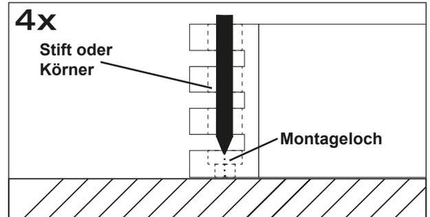
Belassen Sie dann den Prozessor an der gewünschten Einbaustelle im Fahrzeug. Markieren Sie die vier Bohrörter durch das jeweilige Montageloch an den Gussentteilen mit einem geeigneten Stift oder Körner.
