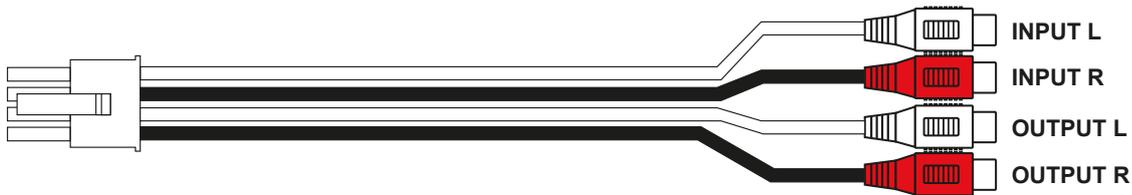
Falls Ihr Steuergerät keine Cinch-Vorverstärker-Ausgänge besitzt, können Sie die Hochpegeleingänge des Verstärkers als Signaleingang verwenden. Schließen Sie dazu die Lautsprecherkabel des Steuergeräts wie folgt an den beiliegenden Kabelstecker an:
