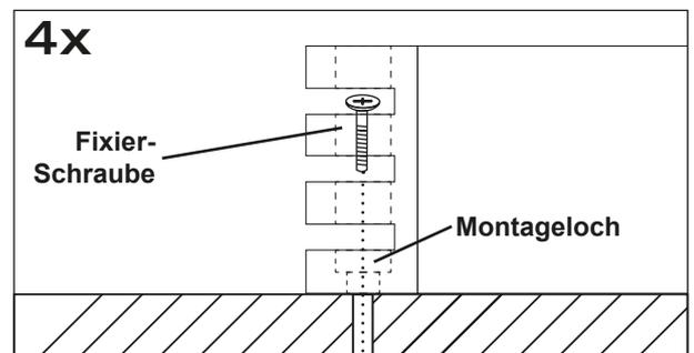
Halten Sie dann den Prozessor wieder an die zuvor gewählte Position und verschrauben Sie den Prozessor mit geeigneten Schrauben an den zuvor gebohrten Bohrlochern mit dem Fahrzeug.
