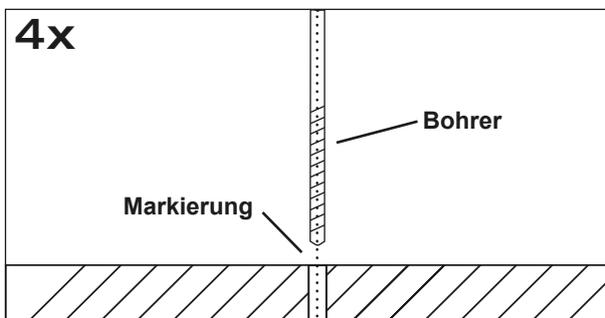
Legen Sie dann den Prozessor beiseite und bohren dann die Löcher für die Fixierschrauben an den zuvor markierten Punkten. Vergewissern Sie sich zuvor, dass keine Kabel, Leitungen und andere Komponenten des Fahrzeugs beim Bohren beschädigt werden. Alternativ können Sie auch (je nach Untergrund) selbstschneidende Gewindefschrauben verwenden.
